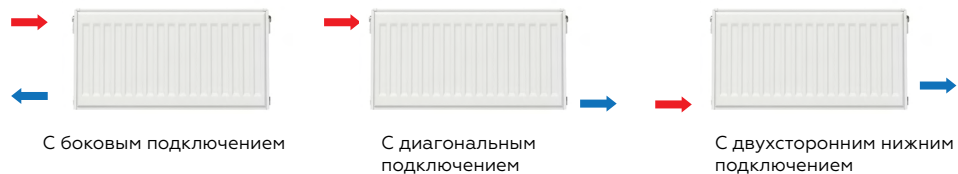
Рис.2 Схема подключения радиаторов серии ERK
