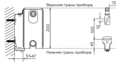
Рис.5 Схема монтажа радиаторов высотой 200 мм
